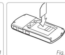
**Fig 1a+b:** Rimuovere il coperchio della batteria
