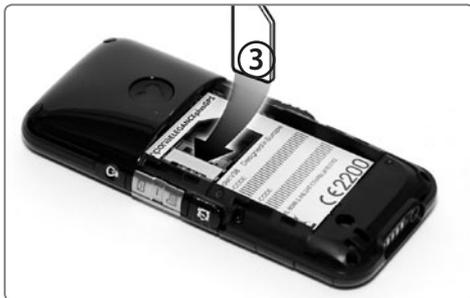
SIM-Karte mit dem goldenen Chip nach unten und dem fehlendem Eck links oben einlegen.
