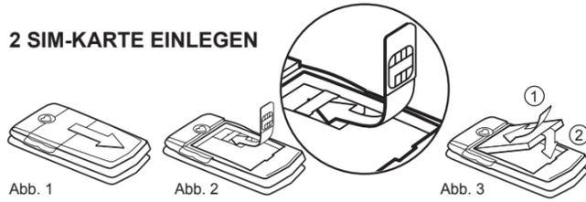
Abb. 1: Akkudeckel entfernen (wie abgebildet).
